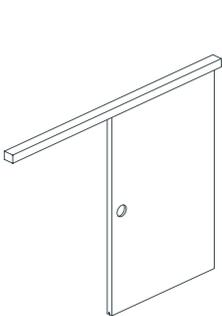
Die Grundversion: Das Schiebetürelement wird direkt auf der Wand montiert. Eine hochwertige Laufschiene sorgt für leises und gleichmäßiges Gleiten der Tür. Der dezente, dekorgleiche Abdeckwinkel deckt die Laufschiene zuverlässig ab. Einfacher gehts nicht.
