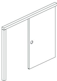
Die Grundversion (links) ist erweitert durch einen Anschlagpfosten. Diese Konstruktion ermöglicht das Abschließen der Schiebetür.
