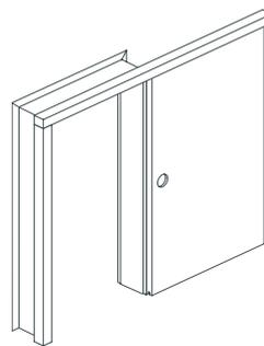
Die Schiebetürkonstruktion mit Zarge (links) ist erweitert durch einen Anschlagpfosten, der das Abschließen der Schiebetür ermöglicht. Mehr Ausstattung geht nicht.
